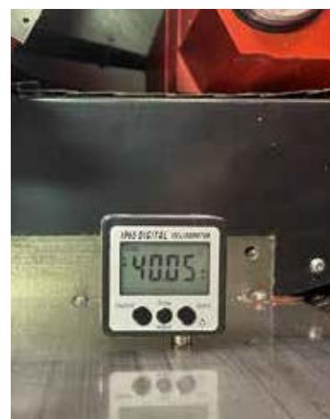
Mit dem digitalen Winkelmesser wird der Winkel der X-Achse gemessen. Der Winkelmesser wird dann mit dem Magnet auf der Ausrichtfläche des Wendeplattensitzes befestigt und die Bohrstange kann dadurch auf den richtigen Winkel eingestellt werden.
