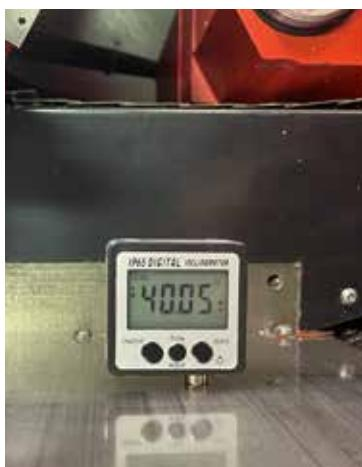
Mit dem digitalen Winkelmeßgerät (Seite 41) wird der Winkel der X-Achse gemessen. Der Winkelmeßgerät wird dann mit dem Magnet auf der Ausrichtfläche des Wendeplatztes befestigt und die Bohrstange kann dadurch auf den richtigen Winkel eingestellt werden.
