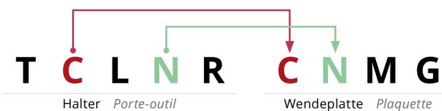
\* Bezogen auf die Wendeplattenbezeichung zur Überprüfung der Kompatibilität
