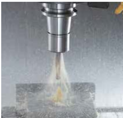
Capuchon avec fentes pour un refroidissement Jet efficace
